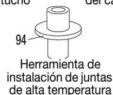
94 Herramienta de instalación de juntas de alta temperatura
